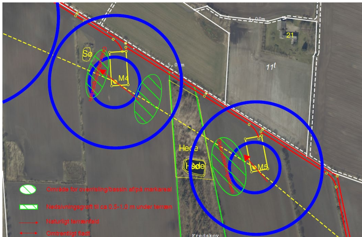
Figur 7.7: Placering af arbejdsarealer ved vindmøller 4-5 (gule firkanter), adgangsveje (røde streger), sænkningstragter ved grundvandssænkning (blå cirkler), nedsivningsområder (grønne ellipser) i forhold til §3-natur.
