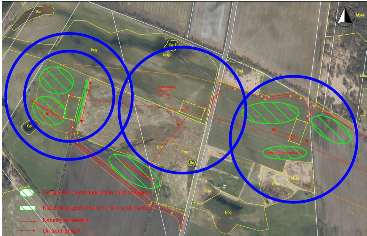
Figur 7.6: Placering af arbejdsarealer ved vindmøller 1-3 (gule firkanter), adgangsveje (røde streger), sænkningstragter ved grundvandssænkning (blå cirkler), nedsivningsområder (grønne ellipser) og nedsivningsgrøft ved VM1 i forhold til §3-natur.
